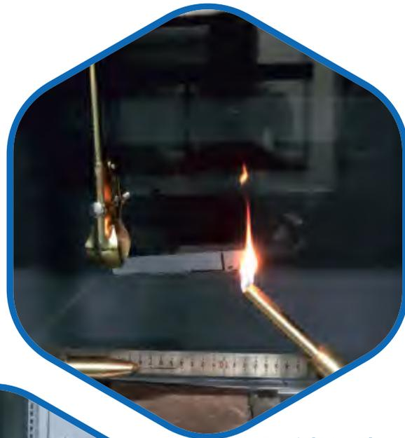
**Essai de Combustion Horizontale à 50W**
